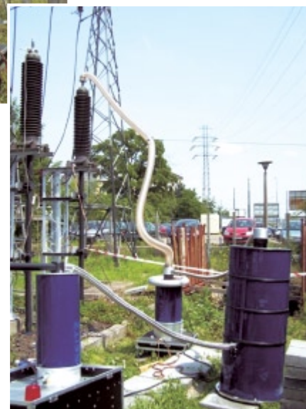
Rys. 1. Badania kabli na stacji elektroenergetycznej w jednej ze spółek dystrybucyjnych
