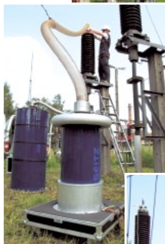
Rys. 1. Badania kabli na stacji elektroenergetycznej w jednej ze spółek dystrybucyjnych
