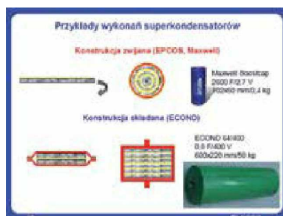
Rys. 6. Przekrój superkondensatora o konstrukcji płaskiej i zwijanej.
