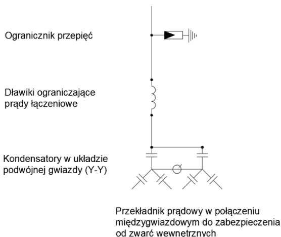
Przykładowy schemat baterii kondensatorów BKW
